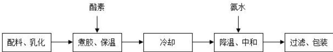
图 3.3-20 水基淀粉胶生产工艺流程图
